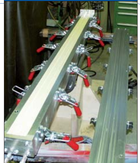
Abb. 5: Form zum Schäumen des Dämmkerns
