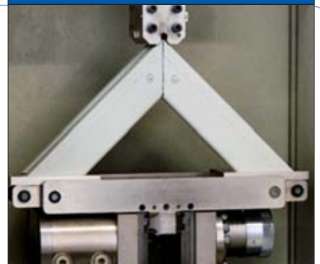
Abb. 4: Prüfapparatur zur Bestimmung der Eckenfestigkeit
